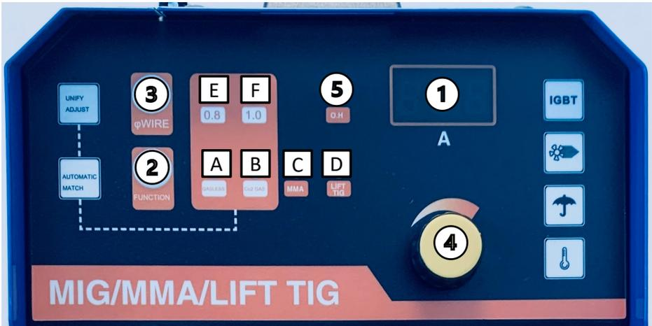
1. Display digitale corrente di saldatura
